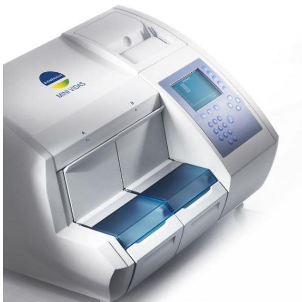
MINI VIDAS® est un système de dosage immunologique automatisé compact basé sur les principes du dosage fluorescent lié aux enzymes. Pratique et convivial, il fournit des résultats de test précis à la demande.
